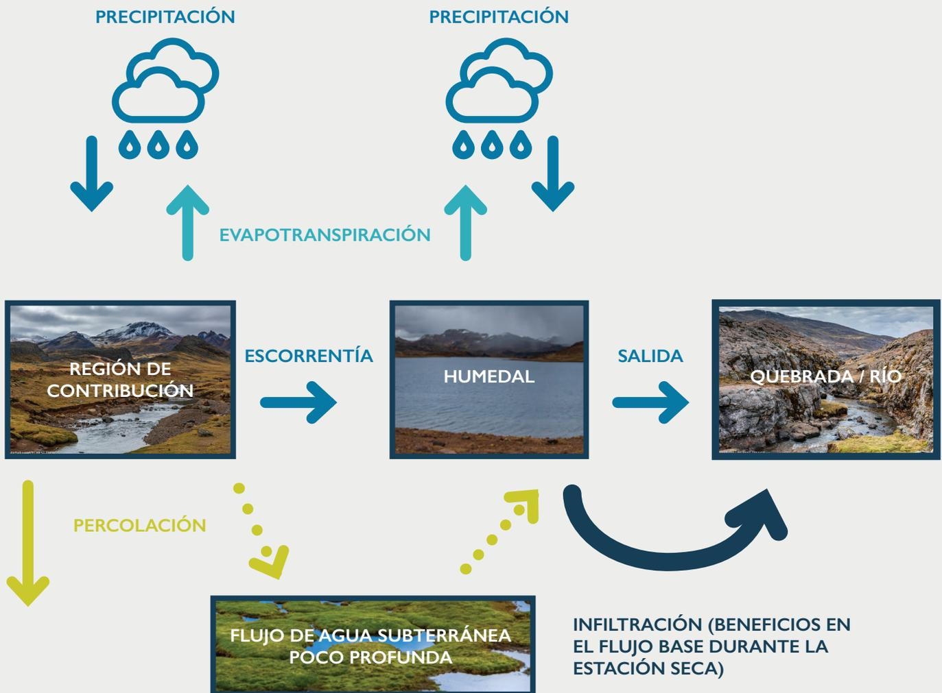
Figura 1. Ilustración del área de contribución y sus interacciones, entradas y salidas del balance hídrico de la restauración y protección de humedales.
