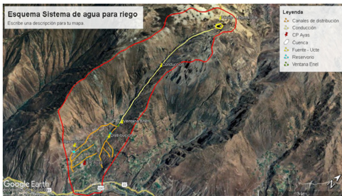
Gráfico 31. Esquema referencial de distribución del sistema de agua para riego
